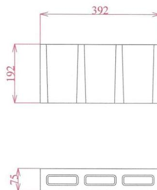
Un bancale contiene 13,92 m<sup>2</sup> e numero 174 blocchi di cui: n° 162 con due teste lisce, n° 12 mezzi a teste lisce.
